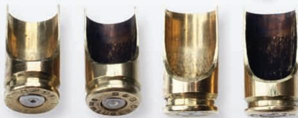
**Saubere Sache:** Innerhalb des Tests wurden 9 mm Luger Handlaborierungen auch gleich mit den schwermetallfreien RUAG Ammotec RWS Zündhütchen verladen. Die beiden aufgeschnittenen Hülsen, links mit schadstofffreiem RWS Zünder und rechts mit üblichem Standardzünder, offenbaren ein sehr deutliches Ergebnis.
