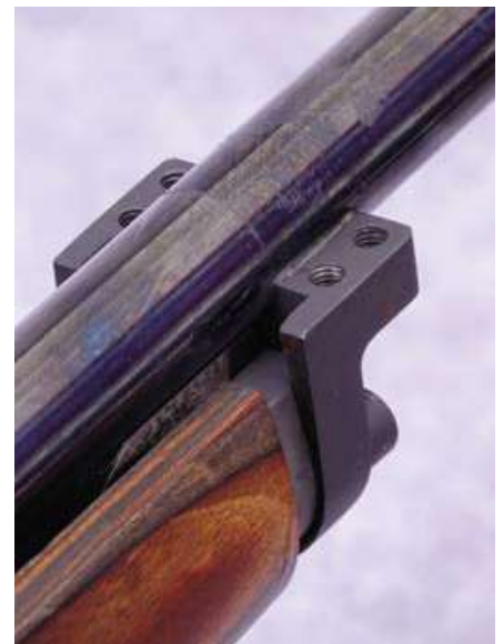
Die Gasentnahmeeinheit wurde modifiziert und der Lauf zusätzlich eingeklebt.
