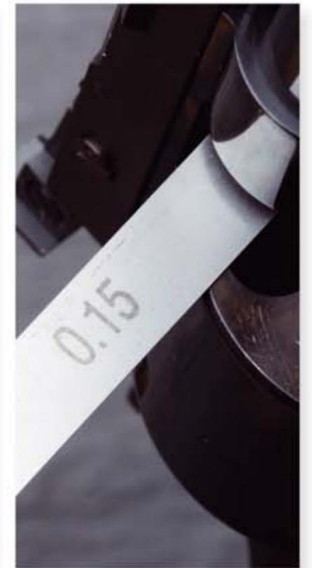
Der Luftspalt zwischen Trommelstirnfläche und Laufwurzel kann justiert und mit der mitgelieferten Fühlerlehre kontrolliert werden.
