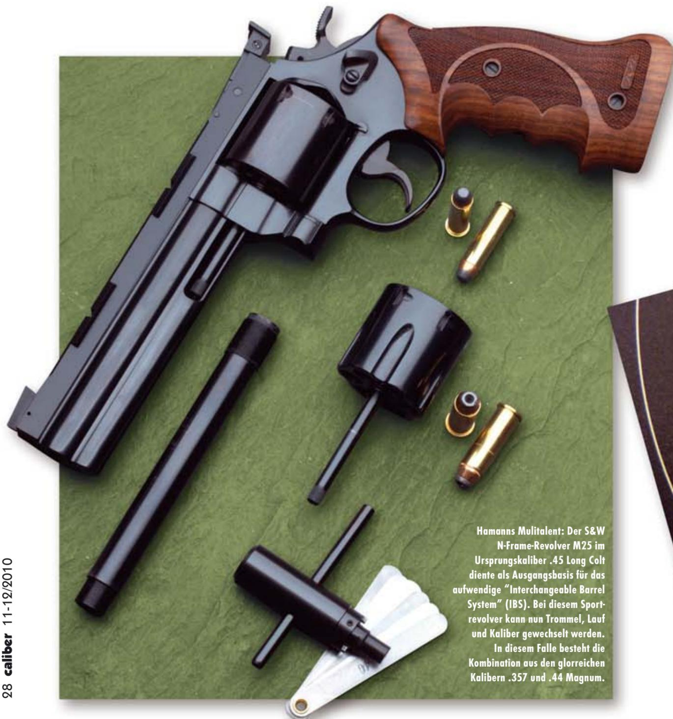
Hamanns Multitalent: Der S&W N-Frame-Revolver M25 im Ursprungskaliber .45 Long Colt diente als Ausgangsbasis für das aufwendige "Interchangeable Barrel System" (IBS). Bei diesem Sportrevolver kann nun Trommel, Lauf und Kaliber gewechselt werden.
