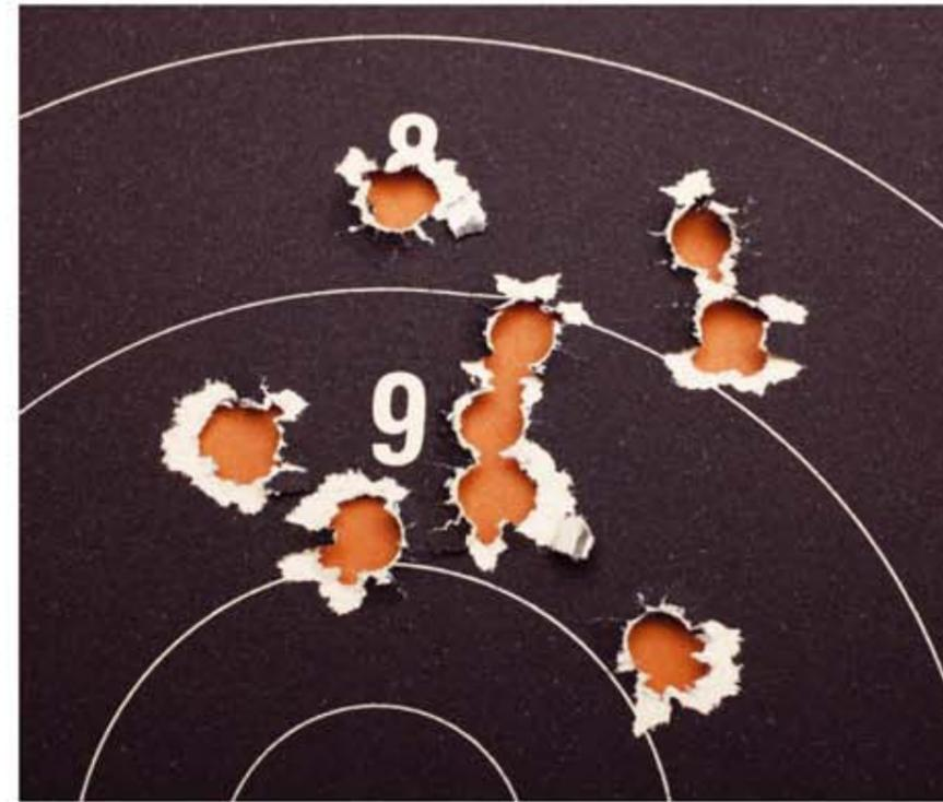
Die 147 Grains schweren Gießbleigeschosse in Kegelstumpfform von Peter Jebens wiesen aus dem Polygonlauf aufgrund der Unterstabilisierung das typische "tipping" auf.
