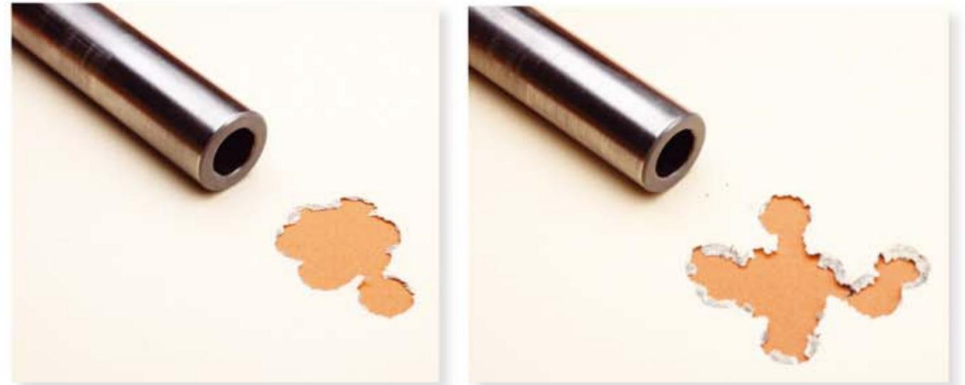
Mit beiden Lothar-Walther-Läufen konnten hervorragende Präzisionsergebnisse realisiert werden, was aber auch der sauberen Einpaßarbeit von Karl Hamann zu verdanken ist. Links der Polygonlauf mit seinem Bestschußbild von 18 mm und rechts der Feld/Zug-Lauf mit seinem Topstreukreis von 29 mm, beide erzielt mit der caliber-Handlaborierung 5,2 Grains Hodgdon Longshot/125 Grains HAP.
